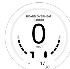
Pregrijavanje elektroenergetskog sustava
